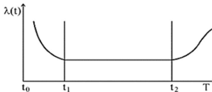
Рисунок 1. – Типичная функция интенсивности отказов
